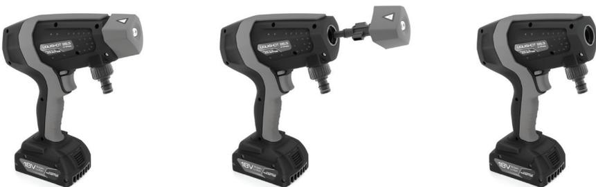
Abb. 7: Entfernung der beigelegten Universal-Düse
